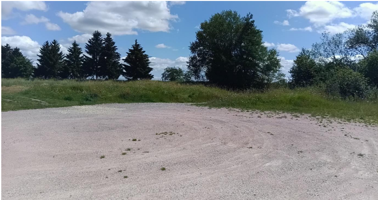
Abb. 16: Mit wassergebundener Decke befestigter Wendeplatz im Westen des UG
